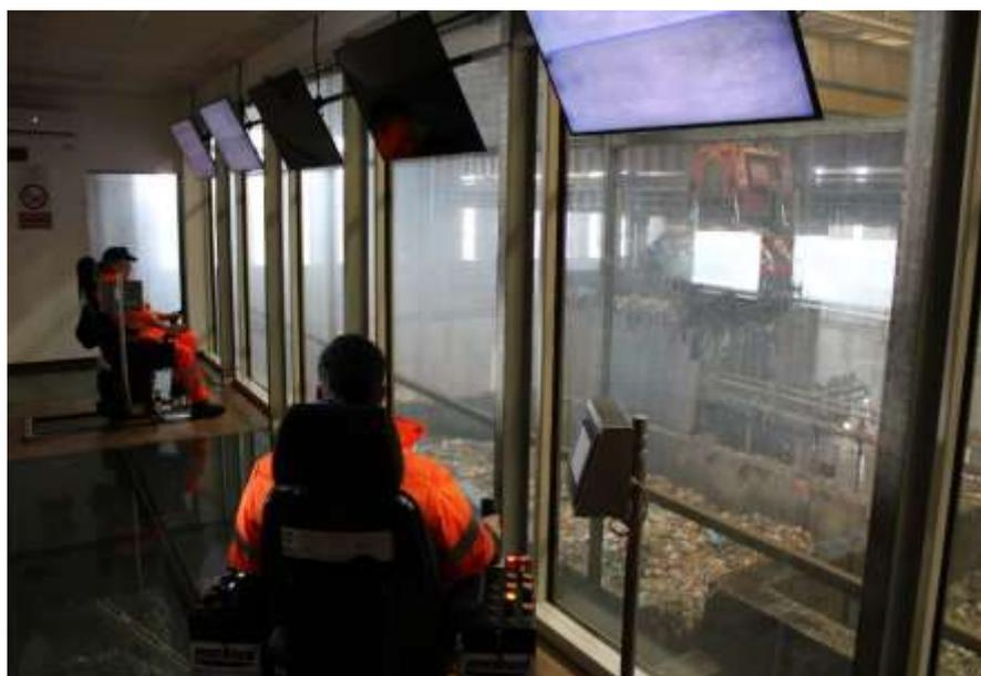
automaticamente da due carriponte elettrici a governo elettronico che, dalle vasche di stoccaggio e messa in riserva seminterrate con volume di stoccaggio autorizzato di 12.000 mc opportunamente dimensionato
