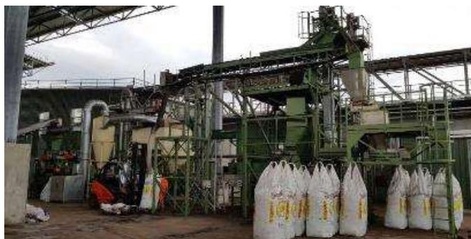
Nel 2019 è stato inserito nel processo di pellettizzazione del compost anche l'impianto di essiccazione della VOMM. Nell'area della bioossidazione lato sud è stato installato un essiccatore per l'essiccamento anche del compost prima del confezionamento/pellettizzazione per abbassarne il contenuto di umidità intorno a percentuali del 12% circa per garantirne le caratteristiche richieste dal mercato.
