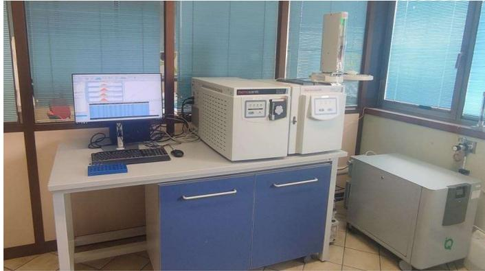
Il nuovo sistema GC-MS/MS per la determinazione PCDD/F e PCB.
