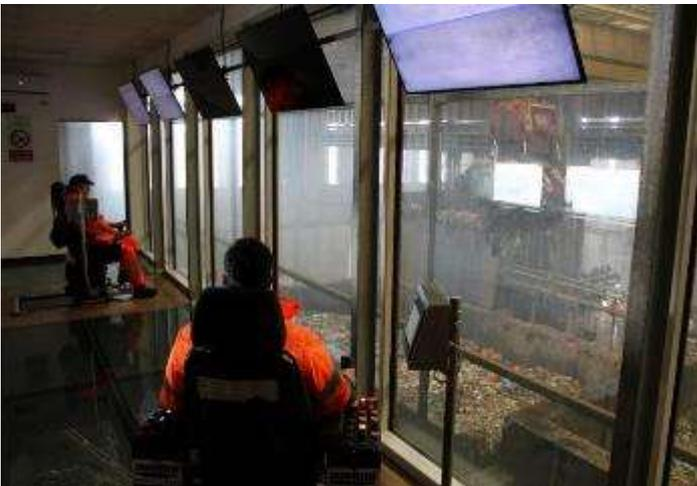
Alimentare le nove linee pretrattamento con i due carroponti consente importanti risparmi di combustibile fossile, gasolio, mentre l'energia elettrica consumata per la movimentazione è autoprodotta dai cogeneratori, ma soprattutto gli operatori che prima erano impiegati nella movimentazione del materiale
