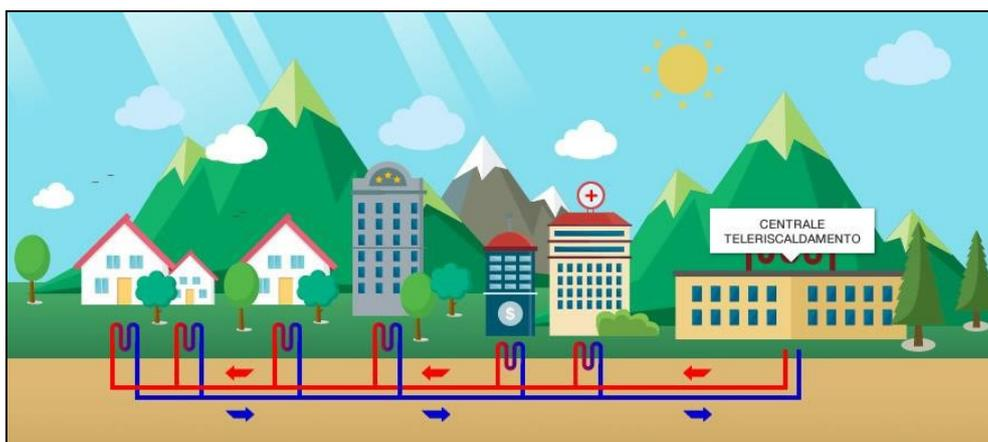
La centrale termica a servizio della rete di teleriscaldamento urbano, ha rendimenti di recupero del calore quasi pari al 100% e, utilizzando una fonte rinnovabile quale il biogas, ha consentito la sostituzione delle vecchie centrali termiche (Ospedale, Collegio Manfredini, Comune di Ospedaletto) nei Comuni di Este e
